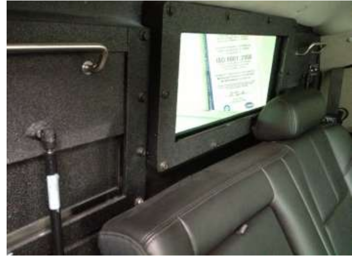
Blindaje en medallón con vista al exterior
