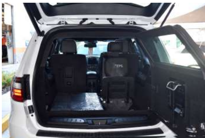
Blindaje de mampara completa
